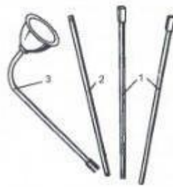
Мал. 2.1. Стетоскоп металевий і дерев'яний: 1 - металевий стрижень з різьбовими кріпленнями, 2 - середній дерев'яний стрижень з різьбовими кінцями, 3 - металева резонаторна коробка, прикладена до вуха.
